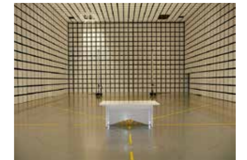
電波暗室(10m法、小型)／外部からの電磁波の影響を受けず、また、外部機器に影響を与えない電氣的に隔離された部屋。
