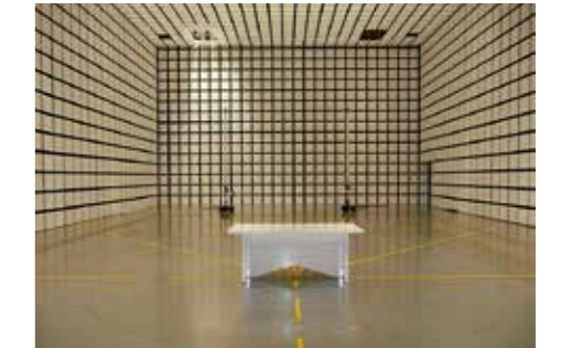
電波暗室(10m法、小型) / 外部からの電磁波の影響を受けず、また、外部機器に影響を与えない電氣的に隔離された部屋。
