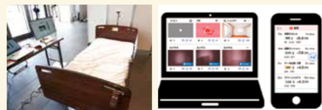
▲同社の見守りシステム「C-エイド」の全景(写真左)。センサーはスタンドに取り付けて頭上(画像の奥側)にセットし、管理室やモバイル(写真右)に状況を表示する。
