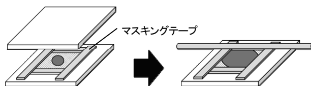
図4 プレス-バーコート法でのコーティング
