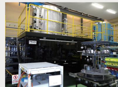
同社は国の支援を受けて進めた表面処理技術の開発で、装置の企画・設計・開発も実施。写真上は「戦略的基盤技術高度化支援事業」(現「成長型中小企業等研究開発支援事業」)の採択を受けて、航空機部品の窒化処理技術を開発する過程で、それを行うために開発された装置「PRIZE」(プライズ)。このプラズマ窒化により、金属表面は極めて硬く改質する。写真下は「イノベーション実用化ベンチャー支援事業」の採択を受けて開発した、深穴形状の金型の内部・深部も均一に硬質なセラミック保護膜を生成する装置「diXis」(ディキス)。
