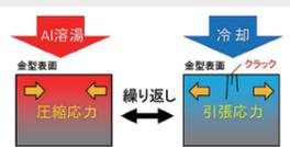
図1 ヒートチェックが発生するメカニズム
