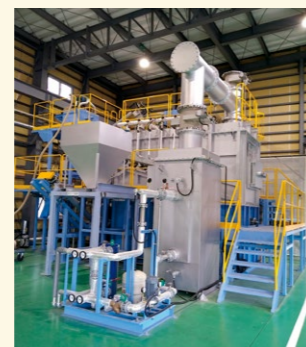
▲「戦略的基盤技術高度化支援事業」の採択を受けて改良された、同社のもみ殻処理炉。
