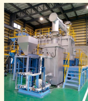
▲「戦略的基盤技術高度化支援事業」の採択を受けて改良された、同社のもみ殻処理炉。
