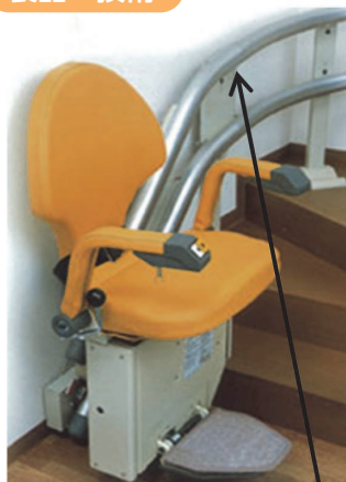
昇降機レールR曲げ加工
