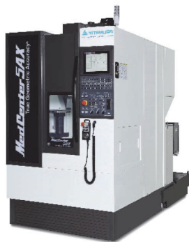
同時5軸制御マシニングセンタ 「Medcenter5AX」と加工例
