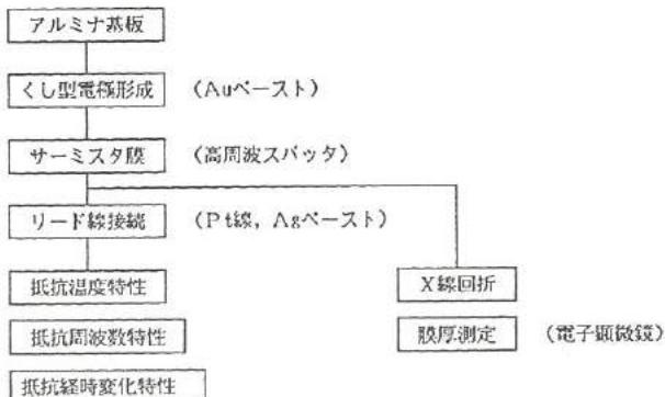
図15 薄膜素子製造工程と測定
