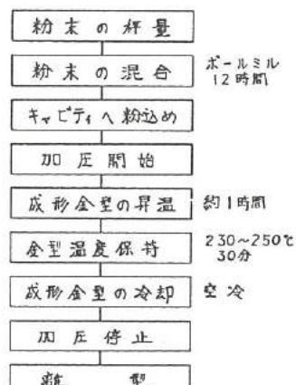
図23 複合材金型の成形手順
