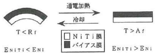
図1 アクチュエータの動作原理
