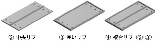
図 14. 曲げ剛性を高めた試験体
