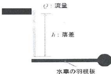
図2. 流路部の物理モデル Fig.2. A physical model of flow path
