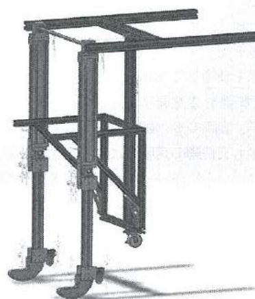
図 15. 運搬用受動的歩行ロボットのモデル
