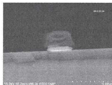
(b) \text{H}_3\text{PO}_4 : \text{HNO}_3 : \text{CH}_3\text{COOH} : \text{H}_2\text{O} = 16 : 0.5 : 8.5 : 8.5 (at 40^\circ\text{C} )
