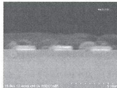
(a) \text{H}_3\text{PO}_4 : \text{HNO}_3 : \text{CH}_3\text{COOH} : \text{H}_2\text{O} = 16 : 0.5 : 4.25 : 12.75 (at 40^\circ\text{C} )
