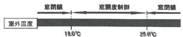
図 14 動作検証用制御ルール Fig.14 The control diagram for the switching action of the window.
