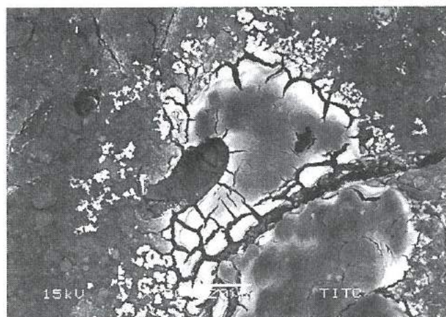
図8 電極析出物の概観とSEM写真
