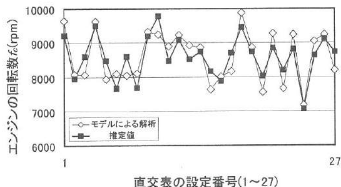
図12 近似推定式による再解析の結果 Fig. 12 Result of reanalysis by approximate estimation expression
