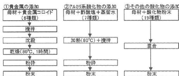
図1 高感度ガスセンサ材料の作成方法
