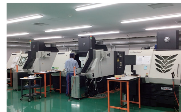
超精密加工が必要とされる機器・部材は温度や湿度が24時間管理される恒温工場で行われる。専門家派遣事業で招いたエネルギー管理士には、恒温工場の効率的なエアコンの使い方の指導も受けた。
