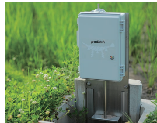
水田の水管理から農業のスマート化に貢献する同社のpaditch(パディッチ)。スマホ等で遠隔で水門の開閉が可能に。深夜の水入れもタイマーで設定可能。畦からの水漏れも検知し、アラートで知らせる。
