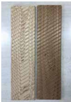
人工空目を施した県産杉の間伐材を利用した圧縮材。
