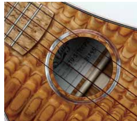
サウンドホールに施された空目金。金と銀を鍛造し、円形に整形してホールの周りにはめ込まれている。板材の厚みは約2mm、空目金の厚みは約1.5mm。
