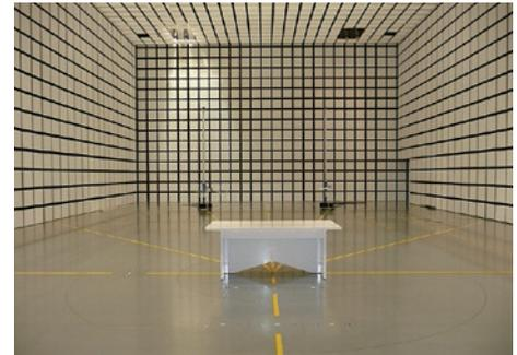
電波暗室(10m法、小型)／外部からの電磁波の影響を受けず、また、外部機器に影響を与えない電氣的に隔離された部屋。
