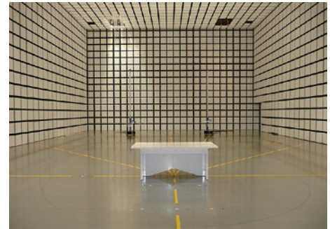
電波暗室(10m法、小型)／外部からの電磁波の影響を受けず、また、外部機器に影響を与えない電氣的に隔離された部屋。
