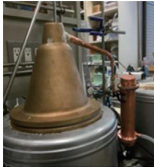
**ものづくり** 食品衛生法に適合する銅製物ウイスキー蒸留器（ポットスチル）の開発（大型鋳物製造業&富山県産業技術研究開発センター）。
