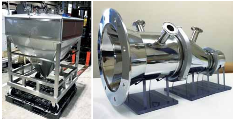
▶▶ 同社製品の代表例。左は化粧品原料の液体貯蔵タンクで、HIRA-tec inc.の銘が付された同社ブランドの製品。右は製薬会社や食品会社用のサニタリー仕様のサンプル。
