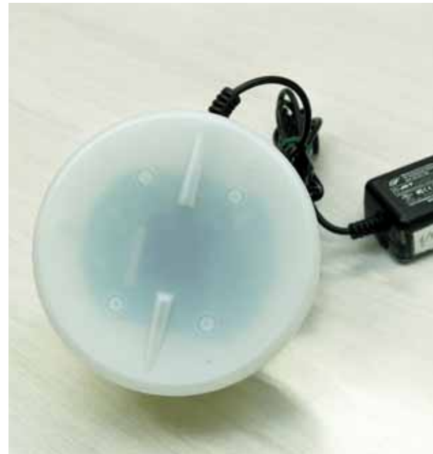
◆非接触・無拘束の生体センサー(製品名「暮らし安心見守りシステム YORI-SOII」)。毛細血管の振動などから呼吸・脈拍などを検知する。5m程度離れていても検知可。
