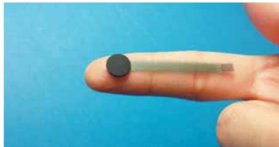
◀ 導電ラバーとペット素材からなるオーギャのセンサの最小単位(上)とロボットの手に実装された状態。
