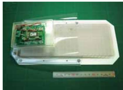
◀ 面圧分布検出の応用からつくられた足の裏の体重移動を検知するセンサ(ものづくり中小企業・小規模事業者試作開発等支援補助金(24年度補正)の適用を受けて、補完的な研究開発も行われている)。
