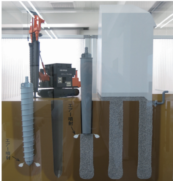
↑ スクリュー・プレス工法を紹介するモデル。スクリューの先端からエアを噴射し、地下水を排除し液状化を抑制する。スクリューを抜く時もエアを噴射すると、パイル状に成形された空洞をつくるができる。
