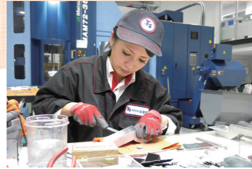
↑ ある航空機部品の製造過程の一コマ。目視によりバリの有無を確認し、手作業で研磨していく。
