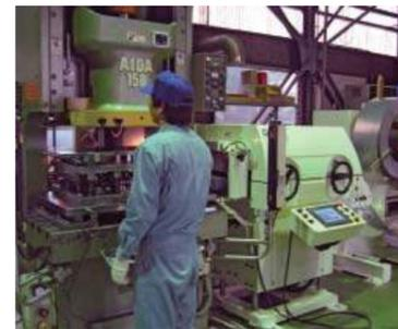
↑ 「ものづくり中小企業製品開発等支援補助金」の採択を受けて同社が開発したパンチング加工機。従来機に比べて20倍の効率がある。
