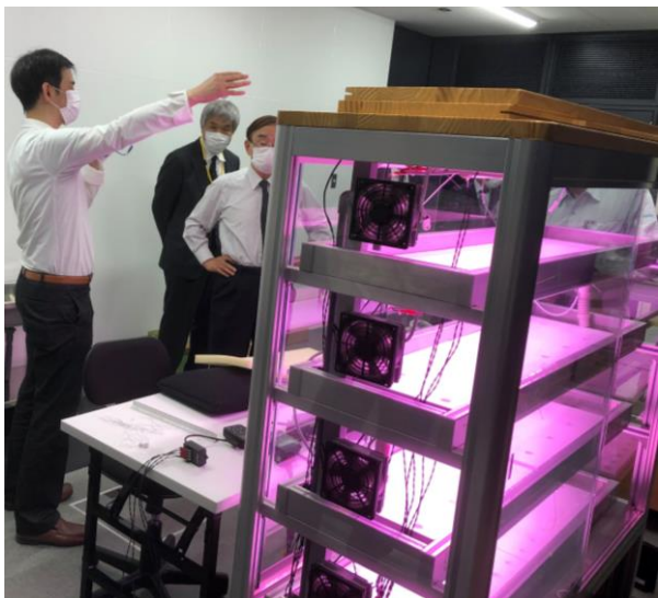
性能試験用LED・アルミ排熱回収部材・樹脂ケーシング (試作ランプシェード)
