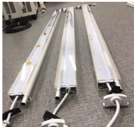
性能試験用LED・アルミ排熱回収部材・樹脂ケーシング (試作ランプシェード)
