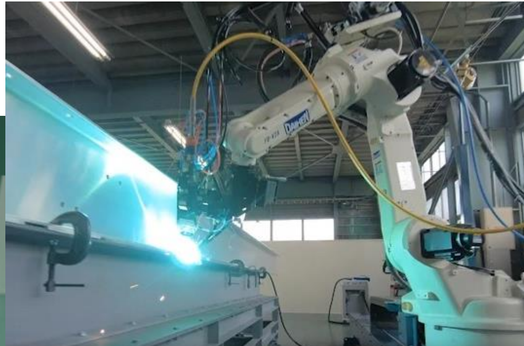
厚肉（10mm）押出アルミ部材の長尺溶接施工の実現
